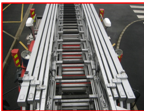
Deux antennes de détection
